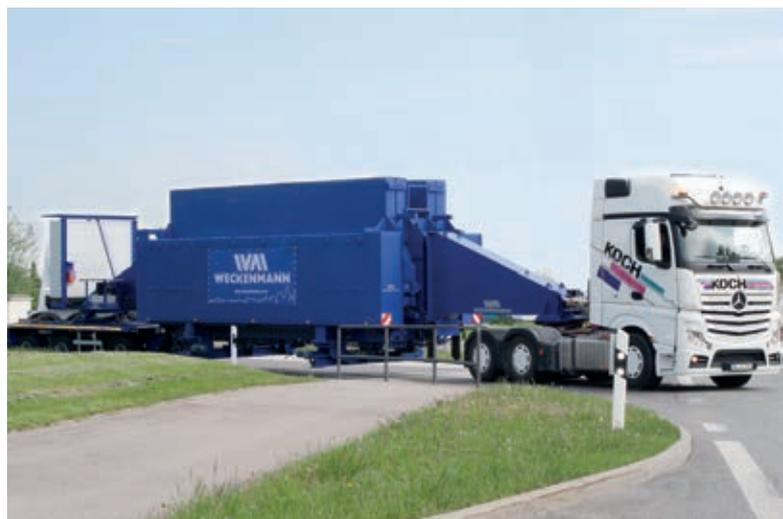
На пути к клиенту: мобильная кассетная опалубка MBM® для вертикального производства массивных стеновых панелей и плит перекрытия
