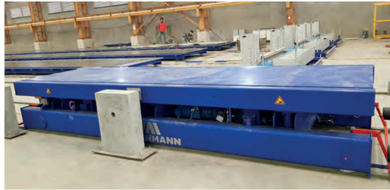
带液压升降平台的落料车，用于取走楼板堆垛
