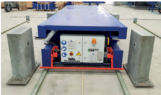
带液压升降平台的落料车，用于取走楼板堆垛
