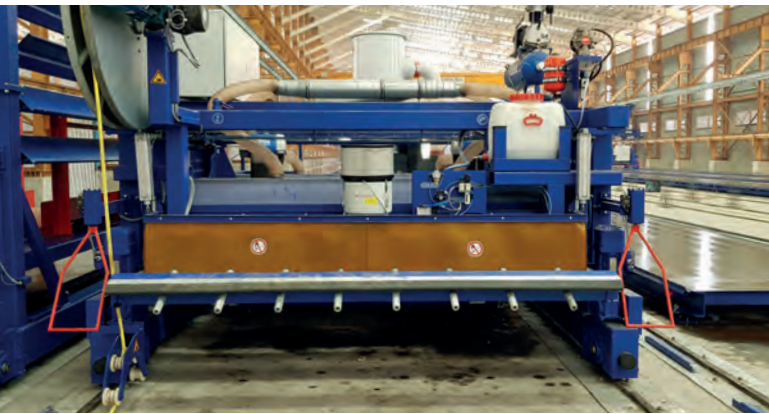
带张紧条的脱扣剂清洗喷淋系统
