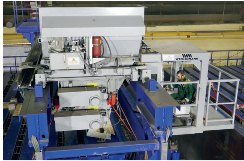
Distributeur de béton sur semi-portique pendant le coulage
