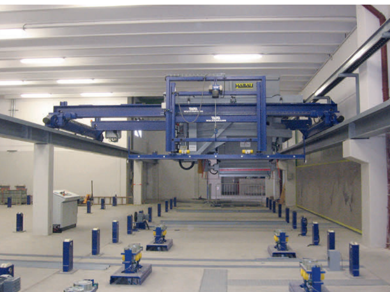
Estación de compactación MagVib en uso en una planta nueva
