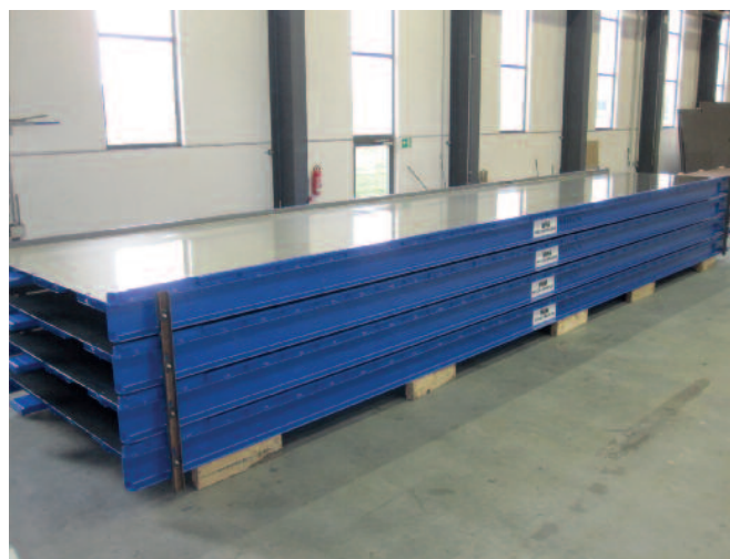
... и после капремонта на заводе Weckenmann: обработанные пескоструем и очищенные от ржавчины и заусенцев
